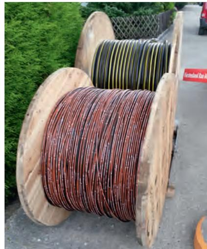
*Rollenweise stehen die Glasfaser- und Stromkabel bereit für den Einzug in die Rohranlagen*
