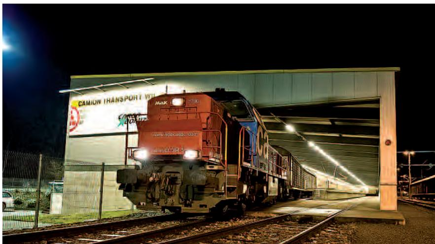
Die schwere Diesellok Am843 von SBB Cargo im Einsatz für die Zu- und Abfuhr der Güterzüge. Foto: Camion Transport AG
