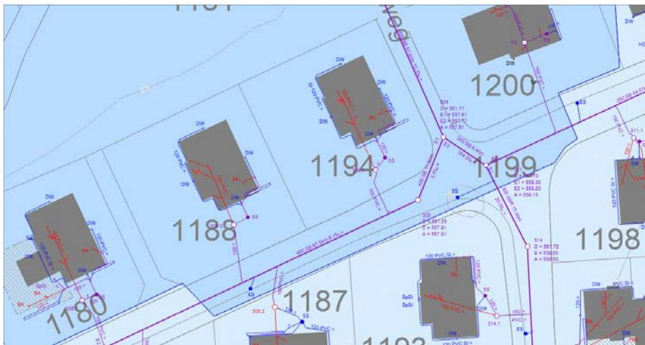
*Auszug aus dem Plan der Grundwasserschutzzone mit eingezeichneten Schmutzwasserleitungen in der Strasse und in einzelnen Liegenschaften (hellblau = Schutzzone S3 / dunkelblau = Schutzzone S2)*
